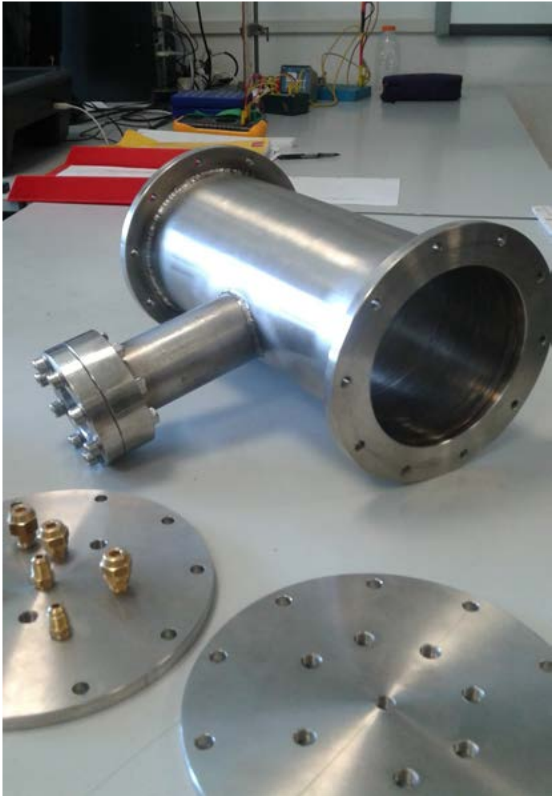
Fig. 8 Camera di contenimento reattore in acciaio inox
