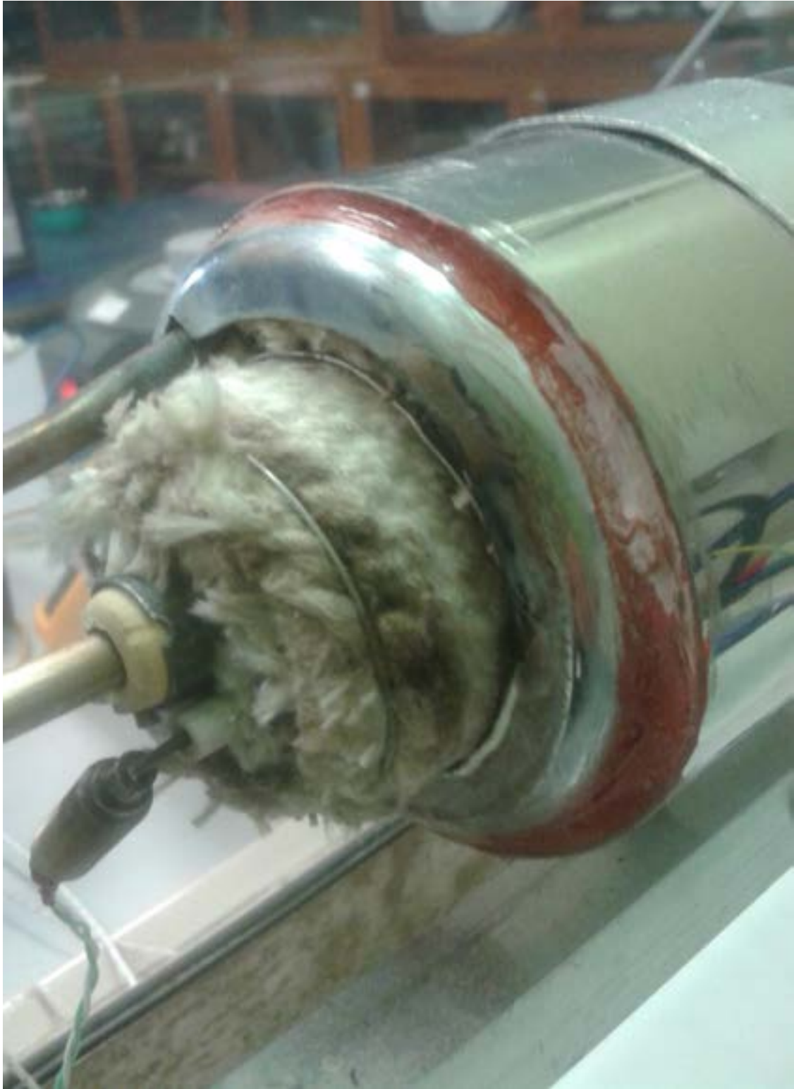
Fig. 13 Particolare del tubo ceramico per la termocoppia e vista della capsula infilata
