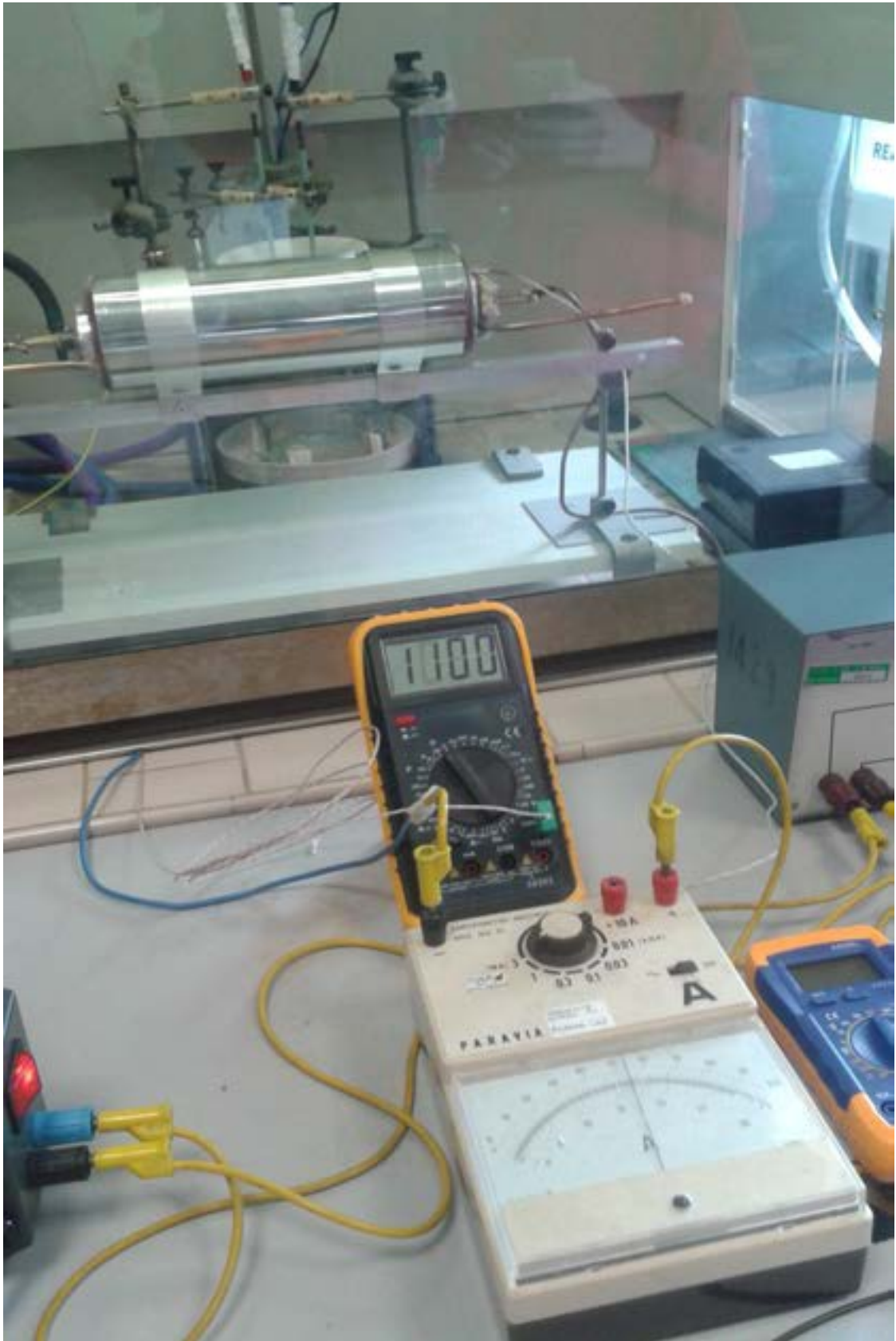
Fig. 6 Tubo acciaio di contenimento dell'isolamento
