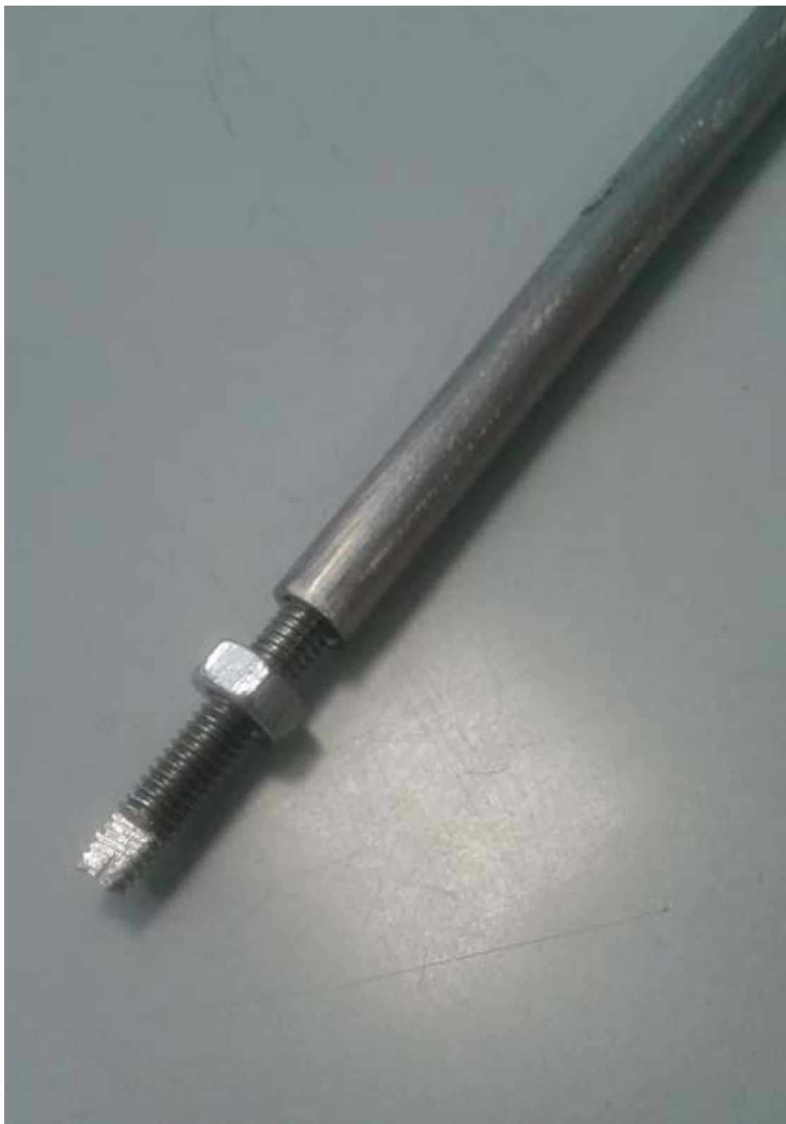
Fig. 12 Capsula inox infilabile e sigillabile con barra filettata per la determinazione del volume di reazione
