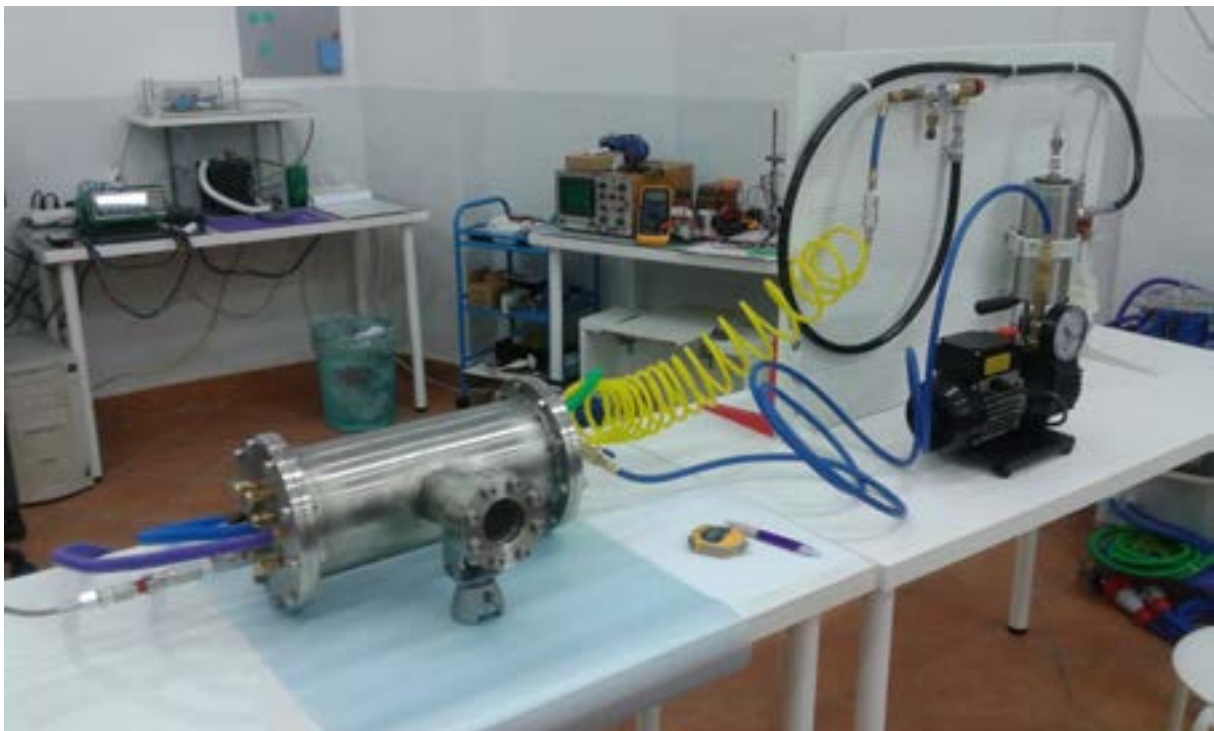
Fig. 17 Sezione scarico controllato, con valvola di sicurezza, serbatoio di espansione, raccolta polveri, abbattimento idrogeno
